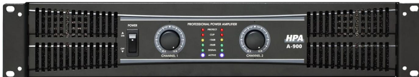
**HPA A-900** Amplificateur 2-canaux avec nombreuses fonctionnalités. La charge minimale admissible en mode stéréo/parallèle est de 2 ohms! 2 x 210W/8 Ohms - 2 x 320W/4 Ohms - 2 x 420W/2 Ohms – Mode bridge 1 x 850W/4 Ohms - Protection-DC - Limiteurs intégrés - Filtre passe-haut HPF.
